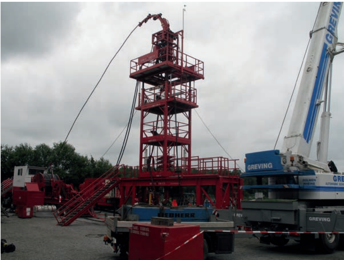
Abbildung 3: Eine aufgebaute CT-Anlage im Kavernefeld Epe
